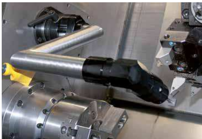
Bras amovible RENISHAW pour mesures d'outils Absetzbares Werkzeugmesssystem RENISHAW Removable RENIS AW tools measuring system
